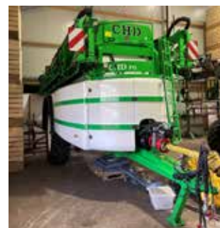
spuitmachine die icm GPS een driftreductie van 97,5% haalt
